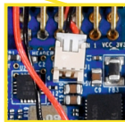
Connect the Fan to SOM Fan Header
